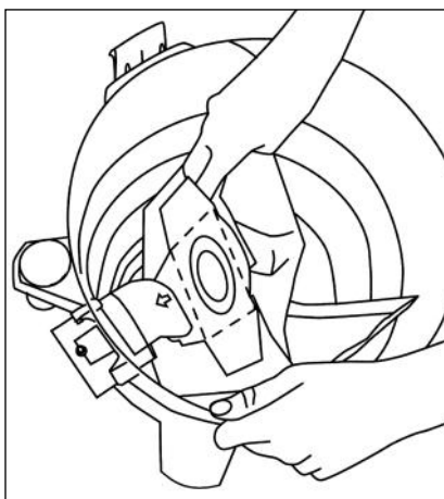
Рис. 6 Установка мешка для сбора пыли
